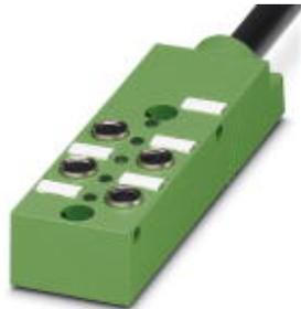
Répartiteur pour capteurs/actionneurs, Application : Standard, Type de raccordement: Connecteur femelle M8 Métal, Nombre de prises: 4, Nombre de pôles: 3, Détrompage: A - standard, Affectation des prises: simple, Affichage d'état: Oui, pnp; Racc. câble multicond.: Connexion fixe 180°, PUR/PVC, Longueur de câble: 10 m, Blindage: non
