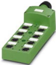
Répartiteur pour capteurs/actionneurs, Application : Standard, Type de raccordement: Connecteur femelle M12 SPEEDCONNNEC Métal, Nombre de prises: 8, Nombre de pôles: 5, Détrompage: A - standard, Affectation des prises: double, Affichage d'état: Oui, pnp; Racc. câble multicond.: Raccordement vissé enfichable 180°, Blindage: non
