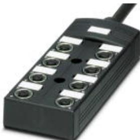
Répartiteur pour capteurs/actionneurs, Application : Extérieur, Type de raccordement: Connecteur femelle M12 Métal, Nombre de prises: 8, Nombre de pôles: 5, Détrompage: A - standard, Affectation des prises: double, Affichage d'état: Non, Universel; Racc. câble multicond.: Connexion fixe 180°, PUR/PVC, Longueur de câble: 10 m, Blindage: non
