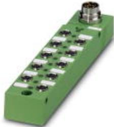
Répartiteur pour capteurs/actionneurs, Application : Standard, Type de raccordement: Connecteur femelle M8 Métal, Nombre de prises: 10, Nombre de pôles: 3, Affectation des prises: simple, Affichage d'état: Oui, pnp; Racc. câble multicond.: Raccordement enfichable M16 90°, Blindage: non
