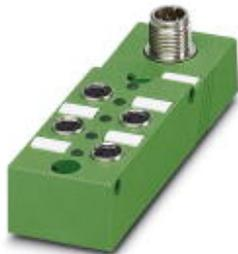
Répartiteur pour capteurs/actionneurs, Application : Standard, Type de raccordement: Connecteur femelle M8 Métal, Nombre de prises: 4, Nombre de pôles: 3, Détrompage: A - standard, Affectation des prises: simple, Affichage d'état: Oui, pnp; Racc. câble multicond.: Raccordement enfichable M12 90°, Blindage: non
