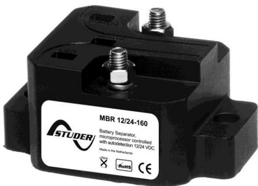
Les séparateurs de batteries (MBR) sont des contacteurs mécaniques de forte puissance pilotés par microprocesseur. Un MBR peut être utilisé lorsqu'un système est composé de 2 batteries (une batterie de démarrage et une batterie auxiliaire) ou d'une batterie de démarrage et des appareils alimentés en courant continu (lampe 12Vdc, etc...) comme par exemple sur des bateaux ou des camping-cars.
