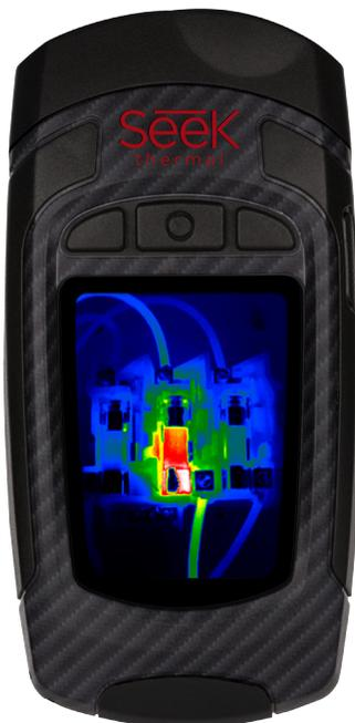
RevealPRO est notre caméra d'imagerie thermique portable la plus avancée. D'une grande durabilité, équipée d'un capteur 320x240 et d'une haute sensibilité, la RevealPRO fonctionne pendant 4 heures en continu avec une seule recharge. Offrant des paramètres de plage thermique, de niveau et d'émissivité réglables, la RevealPRO fournit une imagerie thermique haute résolution sans précédent et des fonctionnalités logicielles disponibles à ce prix.
