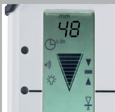
Affichage de la hauteur du laser en millimètres
