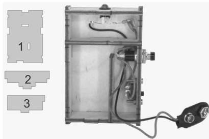
N. Insérez la pile et rangez les fils à l'intérieur du boîtier.
