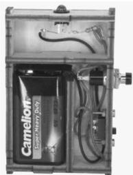
O. Retirez le film de protection du couvercle en acrylique, posez le couvercle sur le boîtier et fixez-le à l'aide des deux rondelles en caoutchouc.
