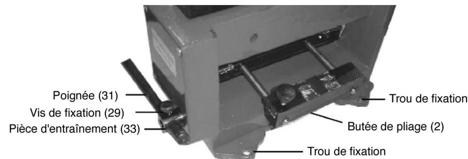
Insérez la poignée (31) dans la pièce d'entraînement (33) et fixez-la avec la vis. Montez la butée de pliage comme indiqué sur la photo.
