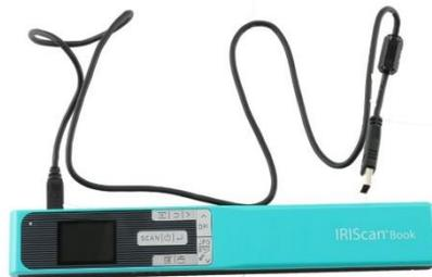
2. Appuyez sur le bouton Scanner/**Mise sous tension**/Entrée pendant 2 secondes pour mettre le scanner sous tension.
