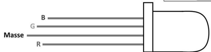
Broches de raccordement d'une DEL RVB
