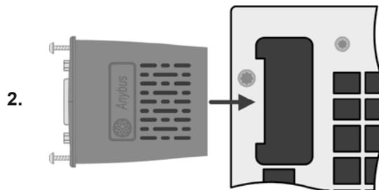
2. Insérez le module d'interface. Sa forme indique le bon sens d'insertion.
