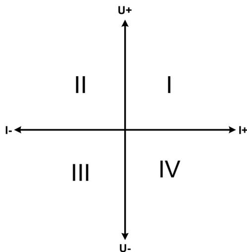
Une combinaison d'une source et d'un récepteur peut uniquement représenter les quadrants I + II. Cela signifie que seules des tensions positives sont possibles. Le courant positif est généré par la source ou l'application et le courant négatif circule dans la charge.
