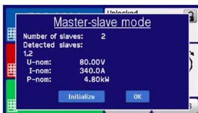
Appuyez sur INITIALIZE pour que l'unité recherche encore des esclaves et se configure automatiquement en fonction des valeurs lues et paramétrées. Si plus qu'une unité correctement configurée est trouvée, alors cet écran indiquera le nombre d'esclaves et le courant total ainsi que la puissance seront combinés.
