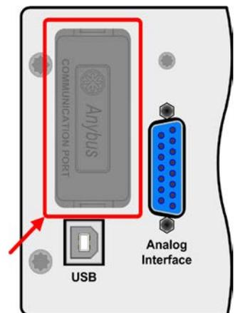
Les modules sont installés par l'utilisateur et peuvent être retirés sans soucis. Une mise à jour du firmware de l'appareil peut être nécessaire afin de reconnaître et vérifier la compatibilité de certains modules.
