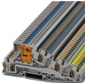
Bloc de jonction pour conducteur de protection d'installation, Raccordement Push-in, Section : 0,2 mm² - 6 mm², AWG: 24 - 10, Largeur: 6,2 mm, Coloris: gris, Type de montage: NS 35/7,5, NS 35/15
