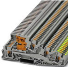
Bloc de jonction pour conducteur de protection d'installation, Raccordement Push-in, Section : 0,2 mm 2 - 6 mm 2 , AWG: 24 - 10, Largeur: 6,2 mm, Coloris: gris, Type de montage: NS 35/7,5, NS 35/15
