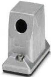
Capot passe-câble HEAVYCONNEC ADVANCE, B10, avec verrouillage à vis (six pans creux) en acier inoxydable, aluminium résistant à l'eau de mer, hauteur 93,7 mm, avec filetage 1x M25, sortie de câble latérale, sans surface ; joint conducteur (propriétés CEM)
