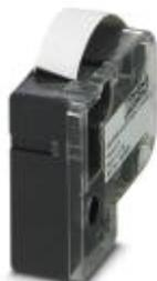
Gaine thermorétractable, sans fin, cassette, blanche avec impression noire, type de montage : à glisser, diamètre de câble : 3,2 - 6,4 mm, repérage possible avec THERMOFOX
