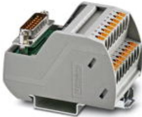
Module VARIOFACE, raccordement Push-in et connecteur femelle D-SUB miniature, montage sur profilé NS 35, nombre de pôles: 9
