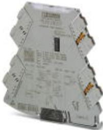
Duplicateur de signaux à 4 voies, à configuration universelle, connectique enfichable pour l'isolation galvanique et la duplication de signaux analogiques. Configurable via sélecteur de codage (DIP) ou par le biais d'un logiciel. Connectique Push-in, configuration standard
