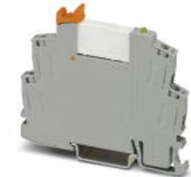
Module à relais prééquipé avec raccordement vissé, comprenant : embase de relais avec éjecteur et relais à contacts de puissance. Type de contact : 1 contact NO. Tension d'entrée : 12 V DC
