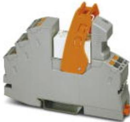
Module à relais prééquipé avec raccordement Push-in, comprenant : embase de relais, relais à contacts de puissance, module d'affichage/antiparasite enfichable et étrier de fixation. Type de contact : 2 contacts inverseurs. Tension d'entrée : 12 V DC
