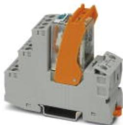
Module à relais prééquipé avec raccordement vissé, comprenant : embase de relais, relais à contacts de puissance, module d'affichage/antiparasite enfichable et étrier de fixation. Type de contact : 2 contacts inverseurs. Tension d'entrée : 120 V A
