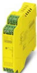
Extension de contact à 1 ou 2 canaux avec plage de tension étendue, 4 contacts NO, 1 contact NF, 1 circuit de report de signalisation, avec appareil de base jusqu'à cat. 4, PL e selon EN ISO 13849, borne à vis enfichable, largeur 22,5 mm
