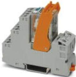
Module à relais prééquipé avec raccordement vissé, comprenant : embase de relais, relais à contacts de puissance, module d'affichage/antiparasite enfichable et étrier de fixation. Type de contact : 4 contacts inverseurs. Tension d'entrée : 24 V AC
