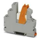
Module à relais prééquipé avec raccordement vissé, comprenant : embase de relais, relais à contacts de puissance, module d'affichage/antiparasite enfichable et étrier de fixation. Type de contact : 1 contact inverseur. Tension d'entrée : 230 V AC
