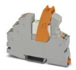
Module à relais prééquipé avec raccordement Push-in, comprenant : embase de relais, relais à contacts de puissance, module d'affichage/antiparasite enfichable et étrier de fixation. Type de contact : 1 contact NO, courant d'enclenchement maximal de 80 A (20 ms), jusqu'à 130 A en pointe, tension d'entrée de 24 V DC
