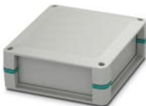
Boîtier complet pour circuit imprimé, positionnement flexible, inclut des demi-coques de boîtier, des parois fermées, support autocollant pour la fixation du circuit imprimé, des vis pour boîtier et fixation du circuit imprimé ; boîtier de couleur gris clair avec inserts de montants d'angle vert-turquoise
