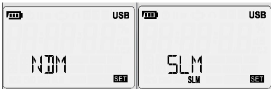
Utilisez les boutons **▲** et **▼** pour modifier le mode de test parmi NDM (Dosimètre) et SLM (Sonomètre).
