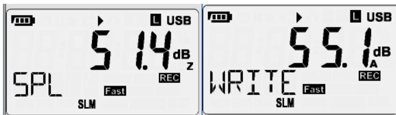
Appuyez sur le bouton
