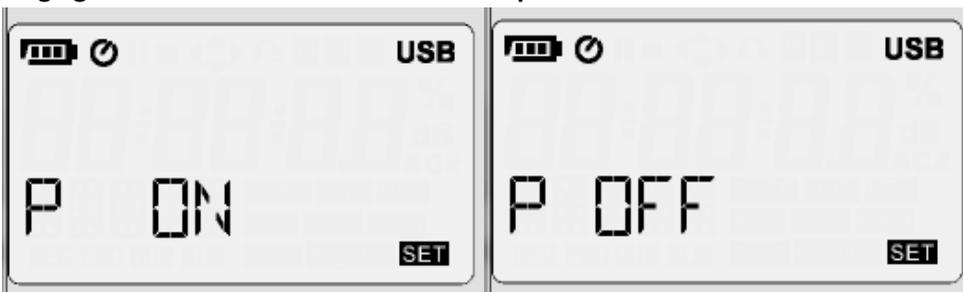
Utilisez les boutons **▲** et **▼** pour activer ou désactiver la fonction Mise hors tension automatique.
