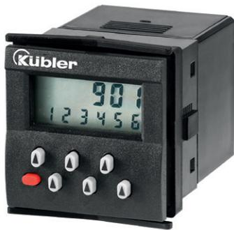
Le modèle 901 est un compteur d'impulsions et horaire à présélection simple alimenté par batterie, avec entrées de comptage et de repositionnement 12 ... 250 V AC/DC ou avec entrée NPN.
