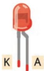
Le sens de montage de la LED est important. Elle est dotée d'un fil plus court (la cathode = pôle négatif) d'un fil plus long (anode = pôle positif). À l'intérieur, un support relativement grand sur lequel est logé le cristal de la LED est visible sur le côté négatif.
