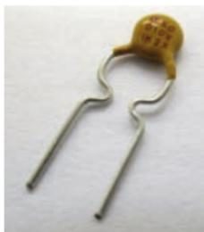
De nombreux fusibles sautent simplement lorsque vous causez un court-circuit. Mais ce fusible spécial est différent. Il s'agit d'un fusible à réarmement automatique, également connu sous le nom de fusible PTC. Lorsqu'une trop grande
