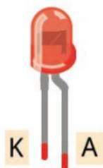
La LED doit être montée dans le bon sens. Le câble le plus court renvoie au pôle négatif (cathode K), et le plus long au pôle positif (anode A). Le plus grand support pour la lumière à cristaux LED est visible de l'extérieur du côté de la cathode. En plus, le boîtier du
