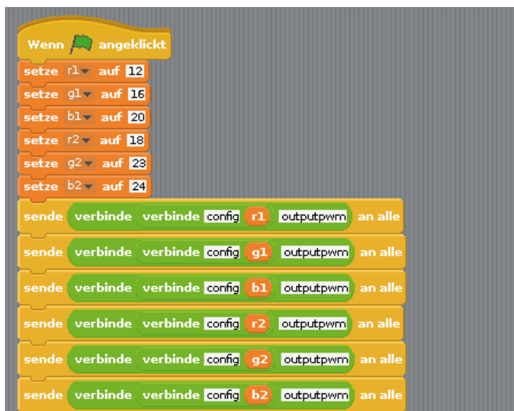
Les programmes 12rgbled12 mélange des couleurs vives sur deux LEDs RVB via PWM.
