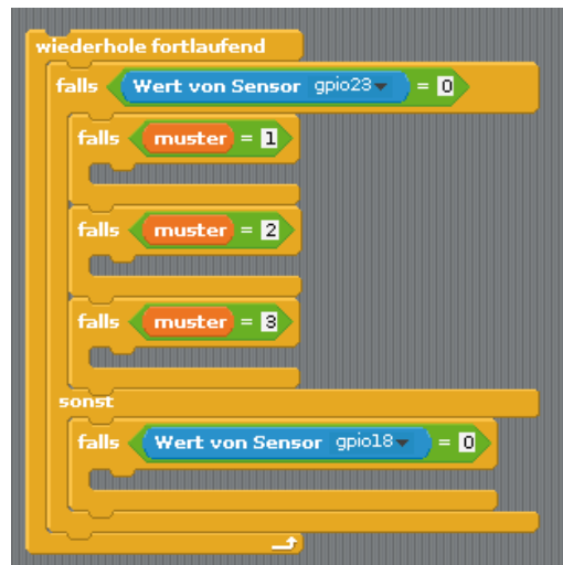
Si on touche le contact de pâte à modeler sur broche GPIO 18, toutes les LEDs sont allumés et éteints à nouveau après une courte pause.
