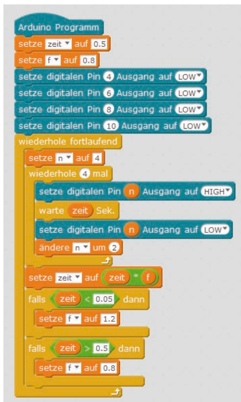
Le programme 10mblock permet d'allumer les LEDs comme un chenillard à vitesse variable.
