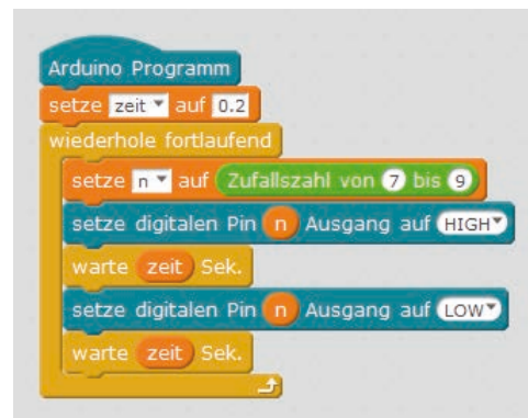
Le programme 07mBlock01 laisse trois LEDs clignoter au hasard.
