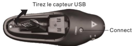
Normalement une fois le capteur USB connecté à un ordinateur, il détectera automatiquement le signal envoyé par le présentateur. Si toutefois, il ne détecte pas en raison d'interférences causées par d'autres dispositifs, appuyez sur Connect pour rétablir la connexion.
