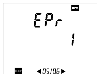
Figure 53 : Affichage du paramètre relatif au nombre d'événement par tour du signal tachymétrique.
