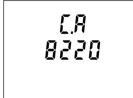
Figure 70 : Le deuxième écran à la mise en marche (pas de capteur de courant connecté).
