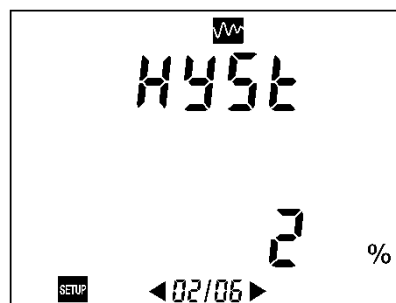
Figure 48 : Affichage du paramètre relatif à l'hystérésis.
