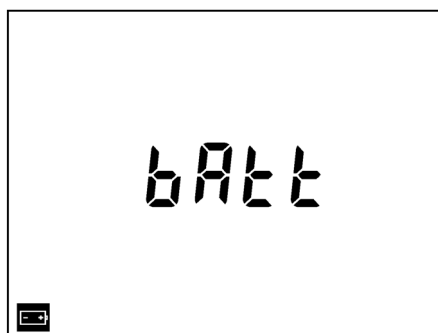
Figure 5 : L'indication de batterie faible nécessitant un remplacement.
