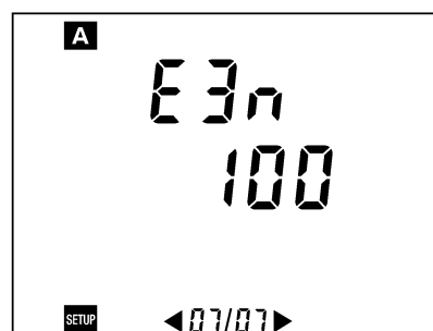
Figure 52 : Affichage du paramètre relatif à la sensibilité utilisée sur la pince.
