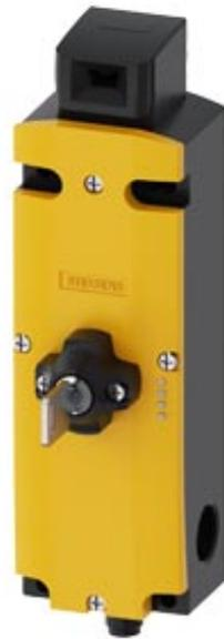
Interrupteur de position de sécurité à interverrouillage Force de verrouillage 1300 N 5 sens d'accostage Boîtier plastique, Connecteur M12 ASIsafe intégré Voie 1 = détrompeur 1 NF Voie 2 = aimant 1 NF verrouillé par ressort Débloccage auxiliaire serrure à l'avant Tension aimant 24V CA / CC Surveillance du détrompeur 2 NF / 1 NO Surveillance de l'aimant 2 NF / 1 NO Le détrompeur individuel adapté 3SE5000-0AV0 doit être commandé séparément
