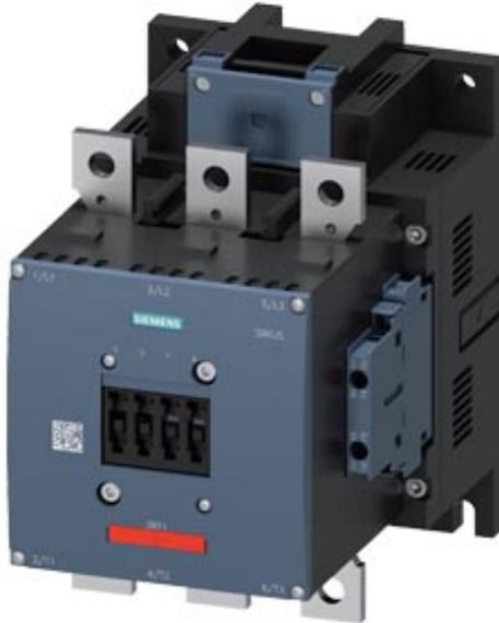
Contacteur de puissance, AC-3 225 A, 110kW / 400V CA (50-60 Hz) / commande DC UC 23-26 V contacts auxiliaires 2 NO + 2 NC 3 pôles, taille S10 Raccordement par barres Entraînement: conventionnel borne à vis Bloc de contacts auxiliaires 2 NO + 2 NF latéral, à gauche + à droite Bloc de contacts auxiliaires non amovible DIN 50012
