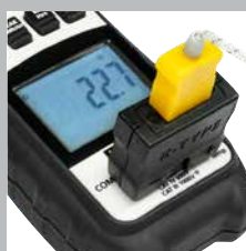
Capteur thermique du type K avec adaptateur
