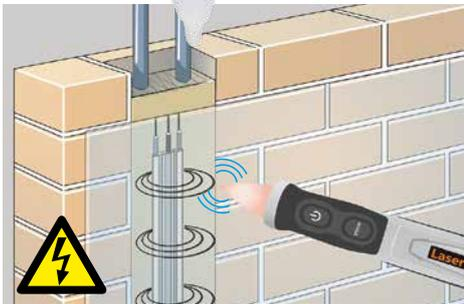
– **Détection sans contact** des câbles sous tension de 12 VCA à 1000 VCA
