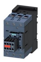
Leistungsschütz, AC-3 80 A, 37 kW / 400 V 2 S + 2 Ö, AC 230 V 50/60 Hz 3-polig, 3S, Baugröße S3 Schraubanschluss Varistor eingesteckt Hilfsschalter unlösbar
