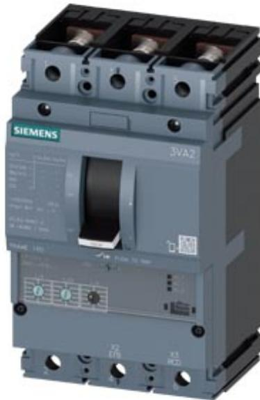
Disjoncteur 3VA2 CEI Frame 160 Classe de coupure H Icu=85 kA à 415 V 3 pôles, protection des installations ETU320, LI, In=100A Protection contre les surcharges Ir=40A...100A Protection contre les courts-circuits Ii=1,5...12 x In Plaque de raccordement par vis Déclencheur à minimum de tension (UVR) 208-230 V CA 50/60 Hz 2 interrupteurs auxiliaires HQ 1 indicateur de déclenchement HQ 1 contact de signalisation de déclencheur de protection
