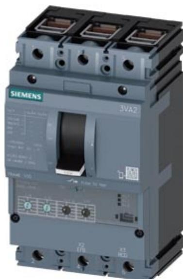
Disjoncteur 3VA2 CEI Cadre 100 Classe de coupure H Icu=85 kA à 415 V 3 pôles, protection des installations ETU350, LSI, In=100A Protection contre les surcharges Ir=40A...100A Protection contre les courts-circuits Isd=1,5...10 x Ir, li=12 x In Raccordement par bornes 1 interrupteur auxiliaire HP 1 indicateur de déclenchement HP
