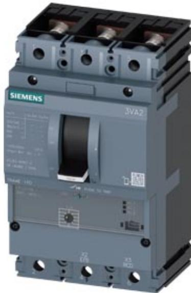
Disjoncteur 3VA2 CEI cadre 160 classe de coupure C Icu=110 kA @ 415 V 3 pôles, protection des départs-moteurs ETU310M, I, In=100A protection contre les surcharges Ir=40A...100A protection contre les courts-circuits Ii=3...15 x In plage de raccordement par vis Déclencheur voltmétrique (STL) 110-127V CC, 50/60Hz CA 2 interrupteurs auxiliaires HQ 1 indicateur de déclenchement HQ
