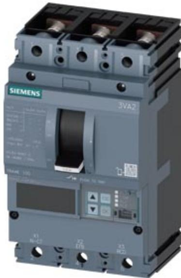
Disjoncteur 3VA2 CEI Frame 100 Classe de coupure M Icu=55 kA à 415 V 3 pôles, protection des installations ETU850, LSI, In=63A Protection contre les surcharges Ir=25A...63A Protection contre les courts-circuits Isd=0,6..10x In, li=1,5..12x In protection du neutre en option avec transformateur de courant Plage de raccordement par vis déclencheur voltmétrique (STL) 110-127V CC, CA 50/60Hz 2 interrupteurs auxiliaires HQ 1 indicateur de déclenchement HQ
