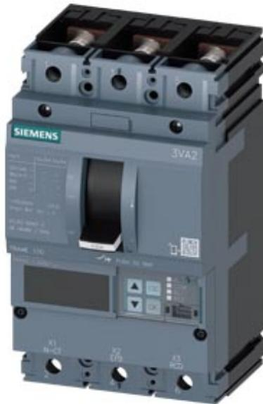
Disjoncteur 3VA2 CEI Frame 100 Classe de coupure M Icu=55 kA à 415 V 3 pôles, protection des installations ETU560, LSIG, In=63A Protection contre les surcharges Ir=25A...63A Protection contre les courts-circuits Isd=0,6..10x In, li=1,5..12x In Protection du neutre en option avec transformateur de courant protection de court-circuit à la terre, désactivable Ig=0,25...1 x In, tg=0,05-0,8s Plage de raccordement par vis 2 interrupteurs auxiliaires HP 1 indicateur de déclenchement HP
