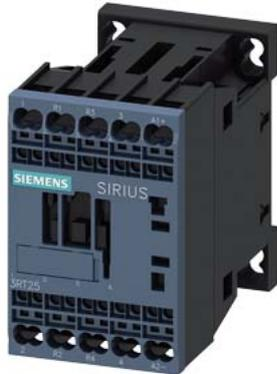
Leistungsschütz, AC-3 12 A, 5,5 kW / 400 V 2 S + 2 Ö DC 24 V 4-polig
