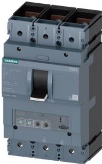
Disjoncteur 3VA2 CEI Frame 400 classe de coupure H Icu=85kA à 415V 3 pôles, protection des installations ETU350, LSI, In=400A protection contre les surcharges Ir=160A...400A protection contre les courts-circuits I<sub>sd</sub>=1,5...10 x I<sub>r</sub>, I<sub>i</sub>=10 x I<sub>n</sub> plage de raccordement par vis 2 interrupteurs auxiliaires HP 1 indicateur de déclenchement HP
