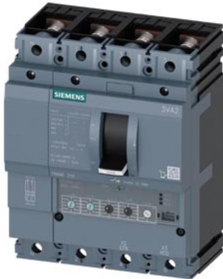
Disjoncteur 3VA2 CEI Frame 250 classe de coupure M Icu=55kA à 415V 4 pôles, protection des installations ETU350, LSI, In=250A protection contre les surcharges Ir=100A...250A protection contre les courts-circuits Isd=1,5...10 x Ir, li=10 x In protection du neutre réglable (OFF, 50%, 100%) plage de raccordement par vis 2 interrupteurs auxiliaires HP 1 indicateur de déclenchement HP
