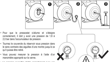
· Vous pouvez mesurer la pression à l'aide d'un manomètre approprié sur la vanne.
