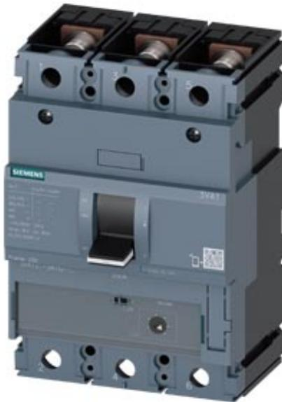
Disjoncteur 3VA1 CEI Cadre 250 Classe de coupure H Icu=70 kA à 415 V 3 pôles, protection des départs-moteurs TM120M, AM, In=200A sans protection contre les surcharges Protection contre les courts-circuits Ii=6...14 x In Plaque de raccordement par vis déclencheur voltmétrique (STL) 110-127V CC, CA 50/60Hz 2 interrupteurs auxiliaires HQ
